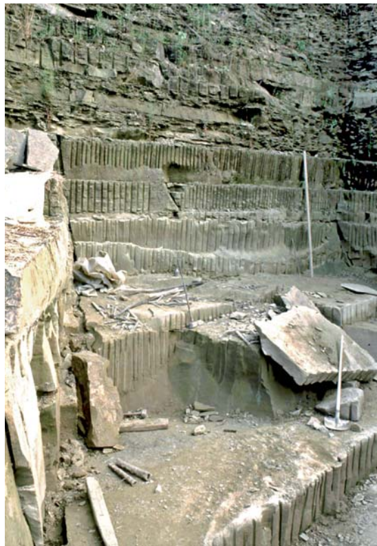
Abb. 20.1 Abbauwand im Sandsteinbruch MELCHIOR in Neuenstein mit unterschiedlichen Abbautechniken. Zustand ca. 1985. Der Steinbruch ist heute aufgelassen. Foto H. HAGDORN.
